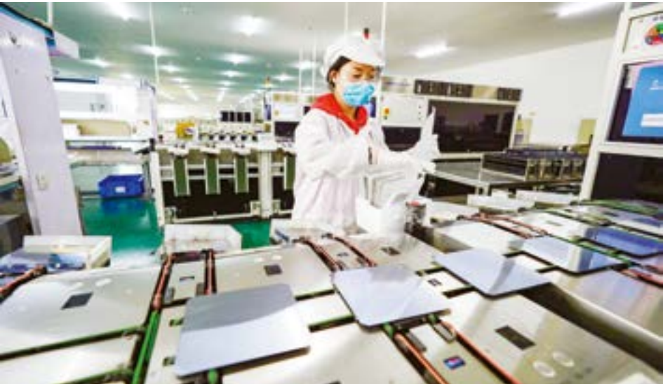
曲靖市阳光新能源股份有限公司技术员对单晶片全自动化分档检测
