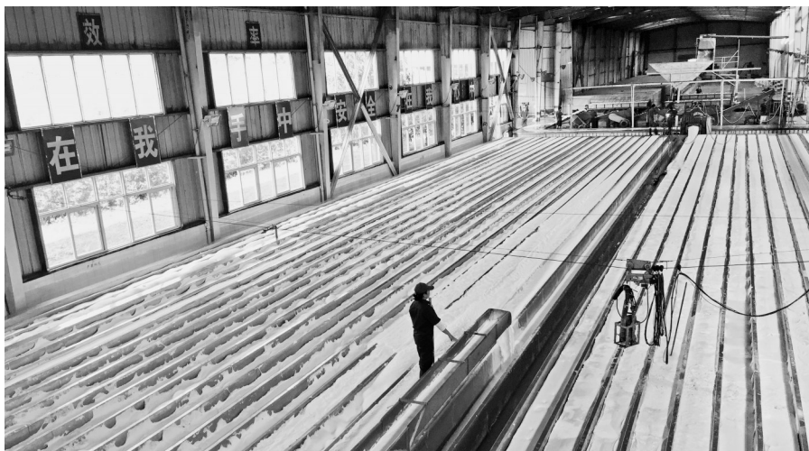
江城橡胶公司胶厂正在加工天然橡胶水
