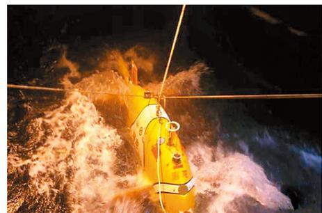
4月20日，我国最先进的自主潜水器“潜龙三号”成功首潜。从凌晨4时46分进入海面，到下午3时53分浮出水面，下潜最大深度3955米，航行24.8公里，顺利完成各项测试指标。
