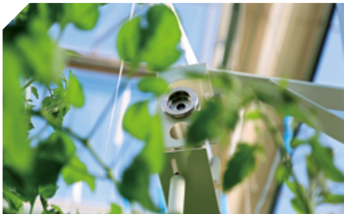
春沐源公司生产基地作物生长数据采集传感器
